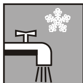
管子露在严寒下，放干 里面的水，防止受冻
