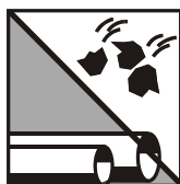
做好防护，防止石头、砖 头等物跌落在管子管件上
