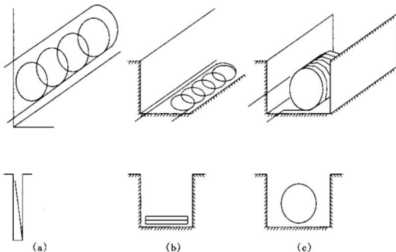
图 2 几种新近开发的水平埋管换热器形式
