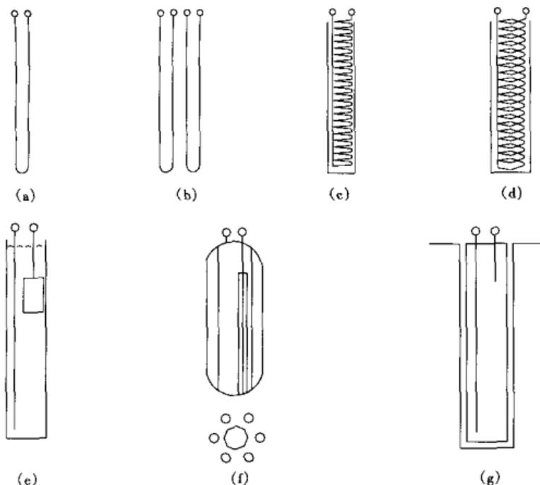
图3 竖直埋管换热器形式
