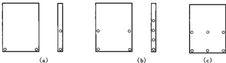
图 1 几种常见的水平埋管换热器形式
