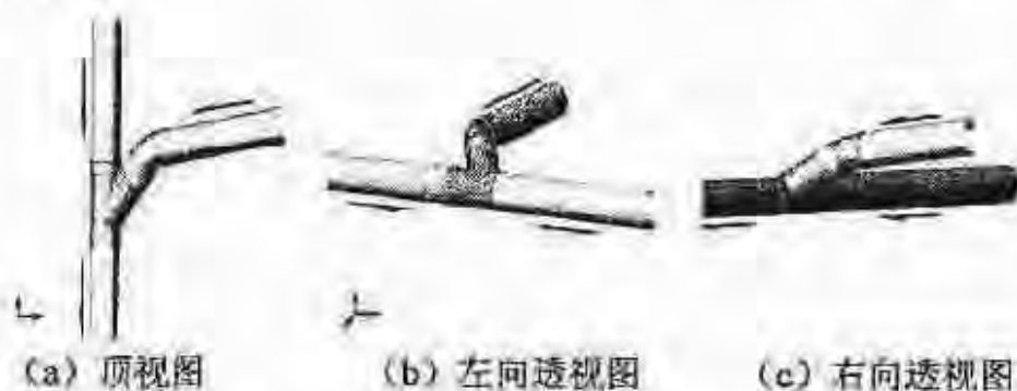
图1 排水横管的水平连接
